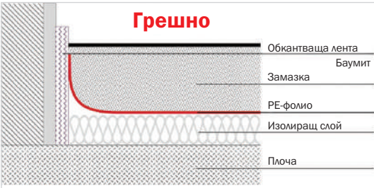
Разделителното фолио образува кухо пространство: Опасност от разрушаване при натоварване поради отслабване на замазката в периметърната област.
