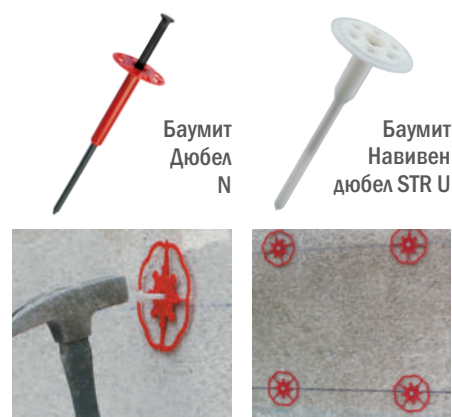
Лепимните анкери СтарТрек са с диаметър на стъблото: 8 mm. Те се вкарват в предварително разпробитите отвори в стената и след това се навива пластмасовият пирон или се навива металният винт. Лепимните анкери се полагат по квадратна схема с растр максимум 40 x 40 cm.
