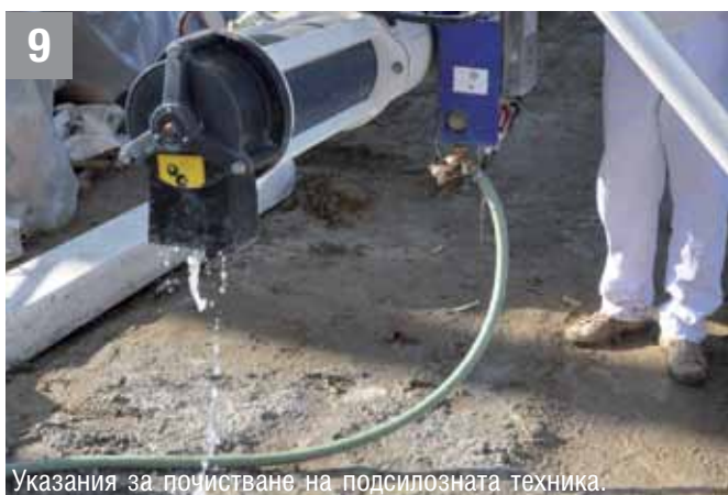
Получената смес е перфектно разбъркана, тъй като в силиконовата тръба лопатките на бъркалната работят в срещуположни посоки, което е непостижимо при работа с класически миксер.
